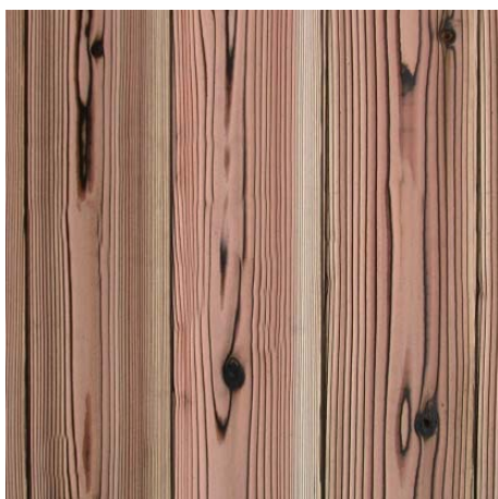
炭化後顏色變濃的晚材部分浮現突出，將其精琢成“浮紋風格”。
