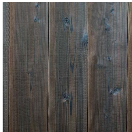
用刷子或布擦磨，將其打磨成具有光澤的燒杉板。
