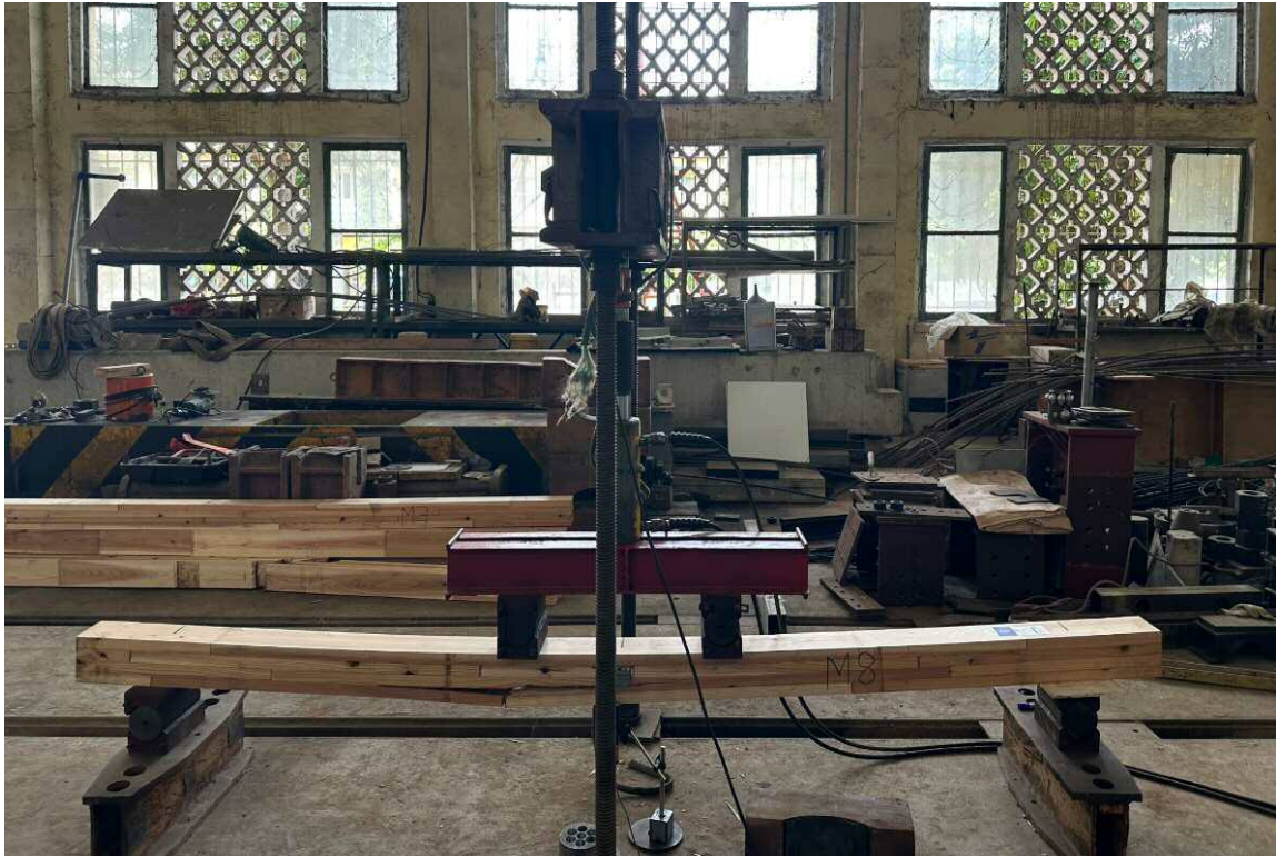
図19. 集成材（GLT）の構造の曲げ試験の画像
