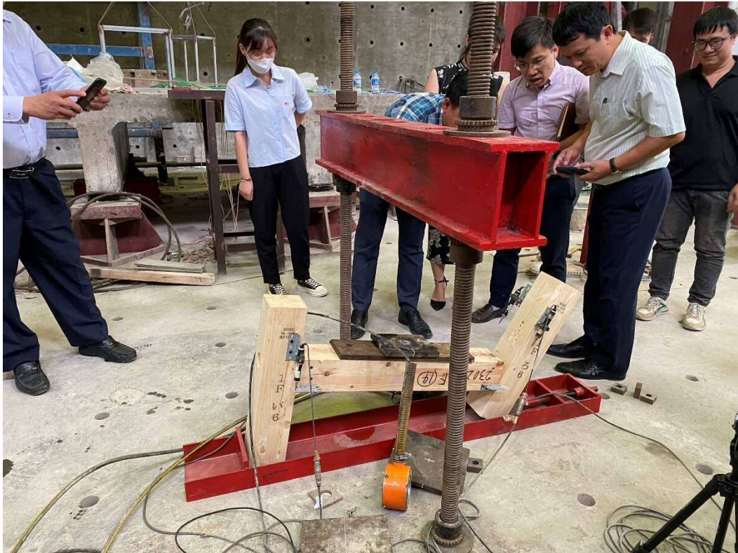
図B.2. タイプ1のせん断試験サンプルの破壊状態-サンプル1
