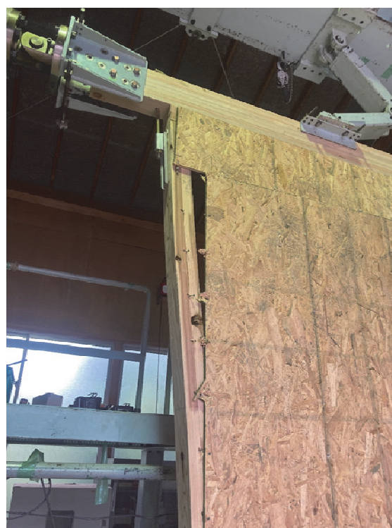
受け材の補強がない場合の破壊状況
