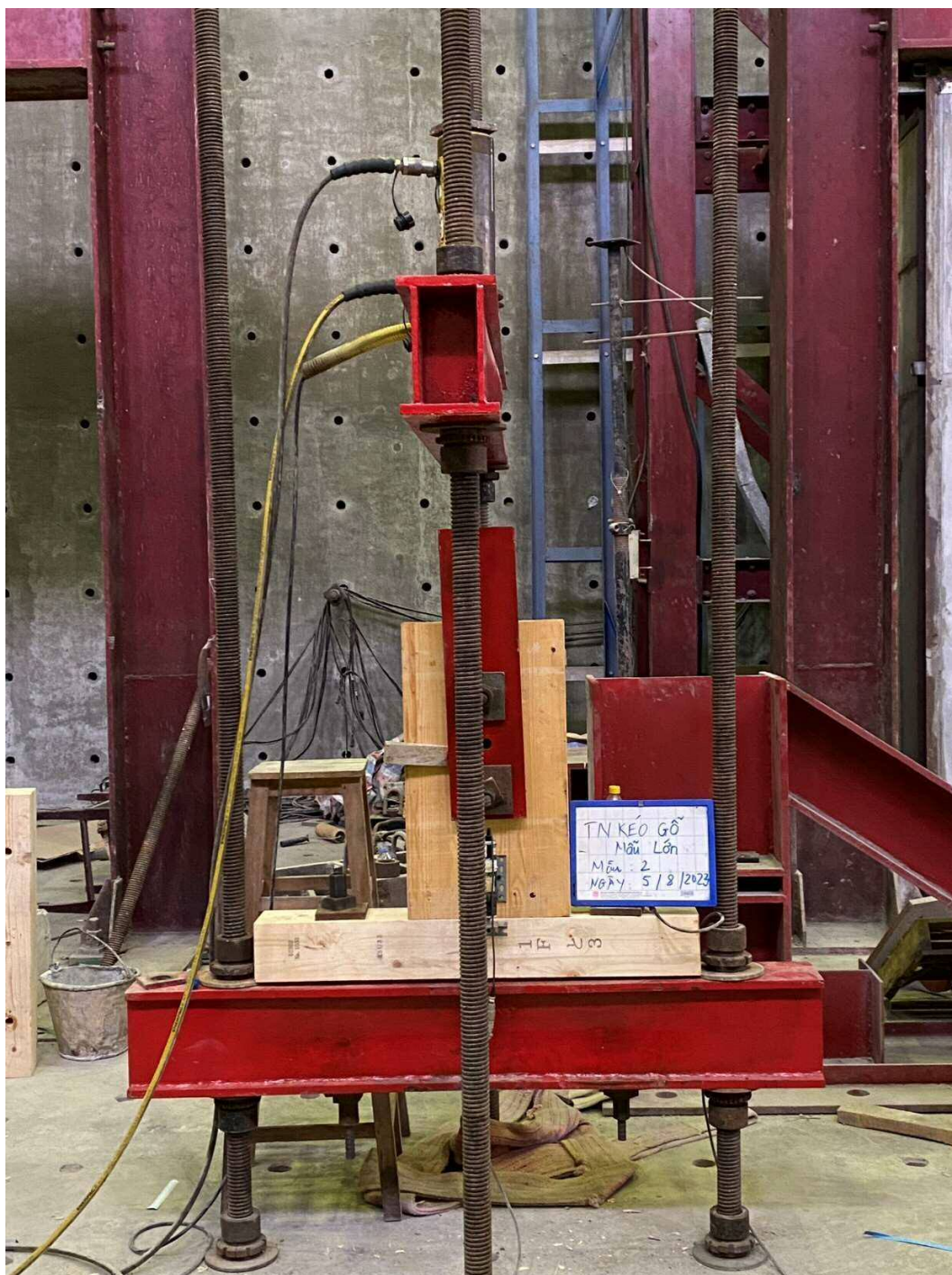
図B.4. タイプ2の柱梁接合部の引張試験-引張サンプル1
