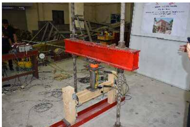
図 4.接合金物の IBST でのせん断破壊試験
