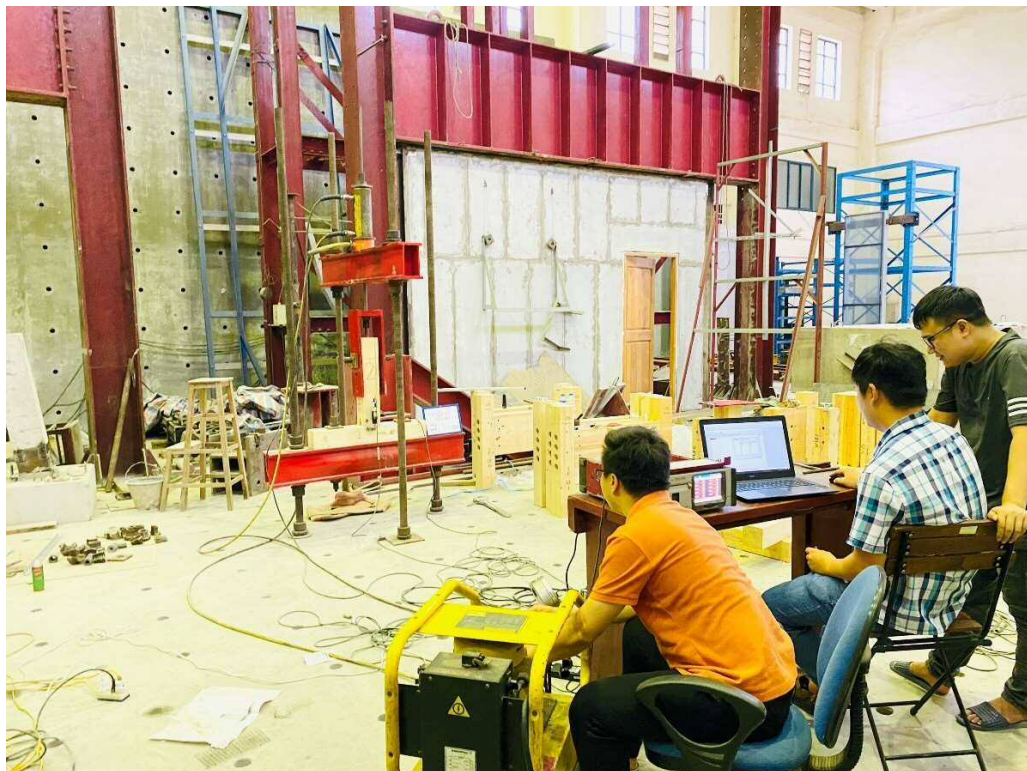
図B.3. タイプ1の柱梁接合部の引張試験-引張サンプル1
