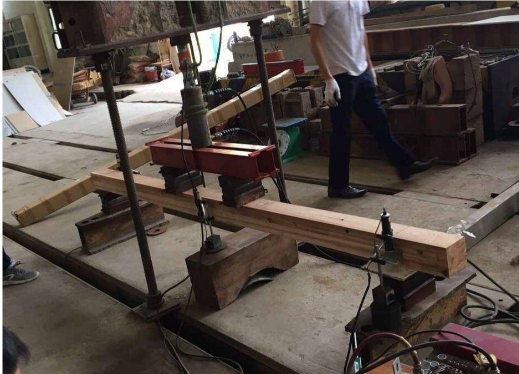
集成材（GLT）の構造の曲げ試験
