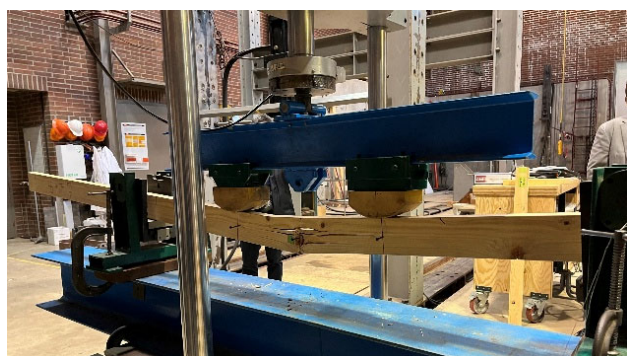
米国検査機関でのスギの強度試験 令和5年11月 (米国オレゴン州 オレゴン州立大学)
