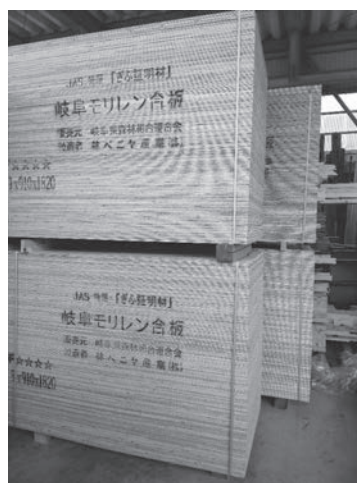
写真 9.18 構造用合板の受け入れ
