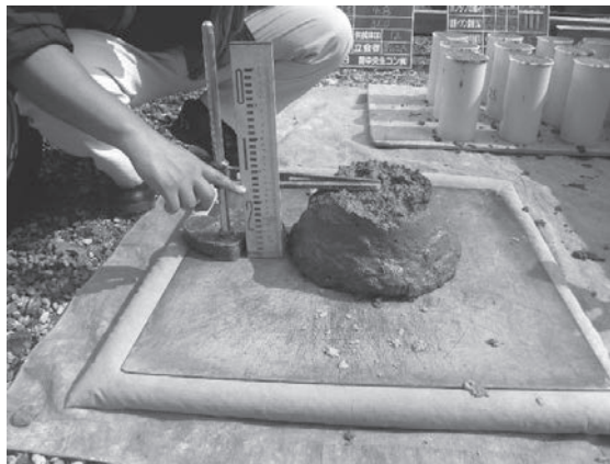
写真 9.7 スランプ・フロー試験
