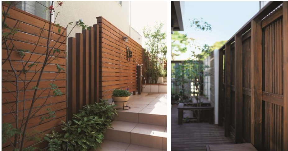
フェンス、化粧隔壁（（スギのサーモウッド）
