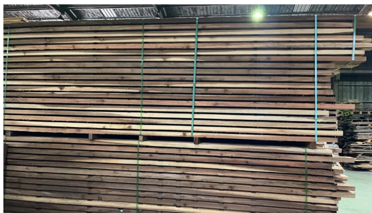
写真 3 - 2 防腐・防蟻処理木材（昆儀実業股份有限公司）
