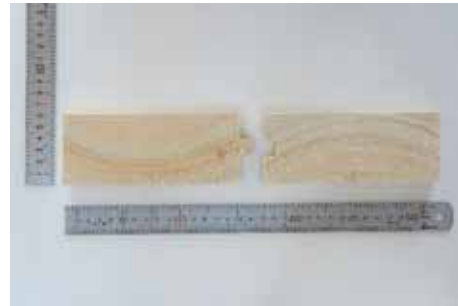
写真-42 製品加工 厚み 65mm 試験体断面 ヒノキ
