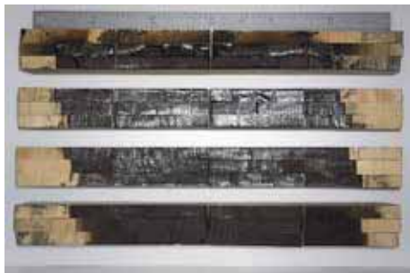
写真-176 試験パネル延焼面抜取り カラムツ 厚 65mm 1 枚目パネル：上段 3 列 2 枚目パネル：下段 3 列 3 枚目パネル：上段 3 列 4 枚目パネル：下段 3 列
