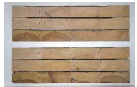
写真-172 試験パネル断面 アカマツ 厚 65mm 3 枚目パネル：上段 3 列 4 枚目パネル：下段 3 列
