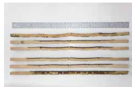
写真-163 試験パネル断面 アカマツ 厚 15mm 3 枚目パネル：上段 3 列 4 枚目パネル：下段 3 列
