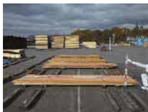
写真-18 製品試験体用原板 品質検査 試験用厚 15mm スギ
