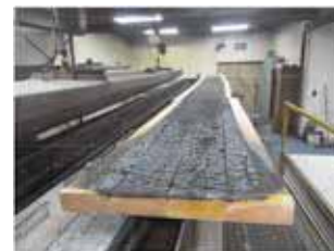
写真-143 試験後/試験面 スギ 65mm 2022 年 2 月 7 日 Intertek
