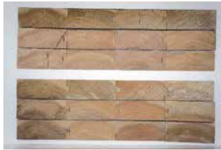
写真-174 試験パネル断面 スギ 厚 65mm 1 枚目パネル：上段 3 列 2 枚目パネル：下段 3 列
