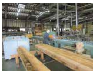
写真-25 表面品質確認した 乾燥後の木材 4m材を 製品加工長さに切断
