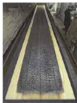
写真-107- 試験後/試験面 カラマツ 15mm 2021 年 12 月 21 日 (社)電線総合技術センター
