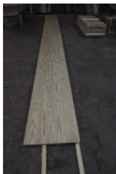
写真-64 製品試験パネル 厚 15mm カラマツ 試験面 日本確認試験用
