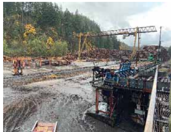
写真 5-3-8 奥側が大径材, クレーンで材が投入される。
