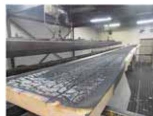
写真-139 試験後/試験面 アカマツ 65mm 2022 年 2 月 7 日 Intertek
