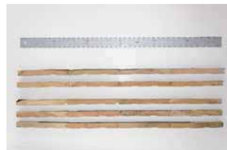
写真-157 試験パネル断面 スギ 厚 15mm 3 枚目パネル：上段 3 列 4 枚目パネル：下段 3 列
