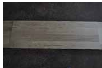
写真-75 製品試験パネル 厚 15mm スギ 試験面 アメリカ試験用
