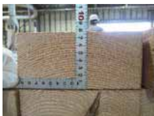
写真-22 製品試験体用原板 品質検査 アメリカ試験用厚 65mm カラマツ
