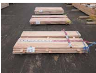
写真-48 製品試験体用原板 試験用厚 15mm スギ、カラマツ、アカマツ、ヒノキ
