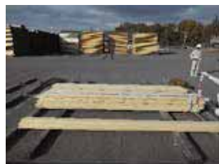
写真-19 製品試験体用原板 品質検査 試験用厚 15mm ヒノキ
