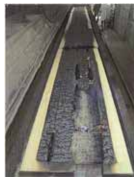
写真-95 試験後/試験面 スギ 15mm 2021年12月20日
