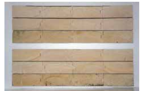
写真-169 試験パネル断面 ヒノキ 厚 65mm 3 枚目パネル：上段 3 列 4 枚目パネル：下段 3 列
