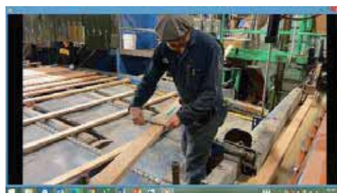
図 5-3-14 ライン上で寸法精度を測定
