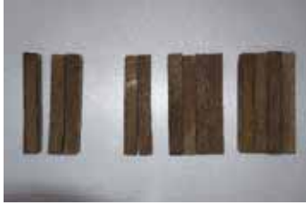
写真-32 日本試験パネル原板 スギ 厚 15mm 用 左からパネル 1、2、3、4
