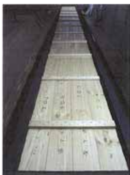
写真-111 試験前 アカマツ 15mm 2021 年 12 月 21 日 (社)電線総合技術センター
