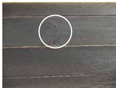
Flaming Drops/火炎落 樹脂(ヤニ)の露出
