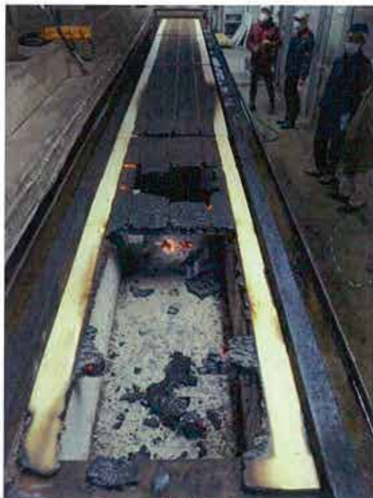
試験後 (燃焼面、バーナーから近い箇所)
