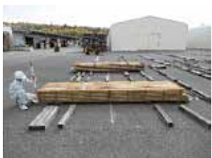
写真-17 製品試験体用原板 品質検査 試験用厚 15mm カラマツ
