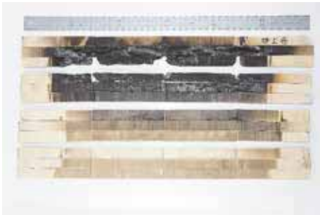
写真-164 試験パネル延焼面抜取り ヒノキ 厚 15mm 1 枚目パネル：上段 3 列 2 枚目パネル：下段 3 列 3 枚目パネル：上段 3 列 4 枚目パネル：下段 3 列
