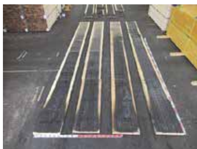
写真-153 試験後試験体パネル 厚み 65mm 燃焼口側 左からヒノキ・スギ・カラマツ・アカマツ
