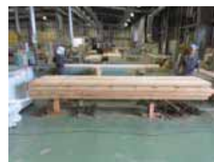
写真-16 製品試験体用原板 品質検査 アメリカ試験用厚 65mm カラマツ
