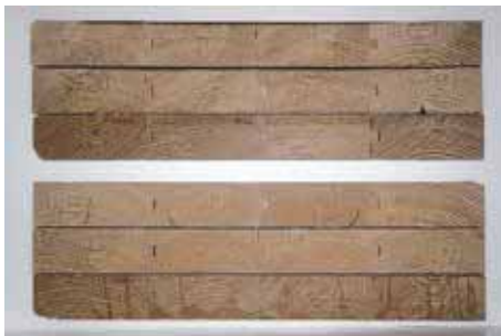
写真-177 試験パネル断面 カラムツ 厚 65mm 1 枚目パネル：上段 3 列 2 枚目パネル：下段 3 列
