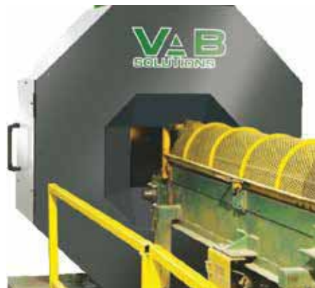
写真.5-5-14 PLANER MILL LUMBER GRADER 2nd GEN の外観 (出典：VAB Solutions カタログ)
