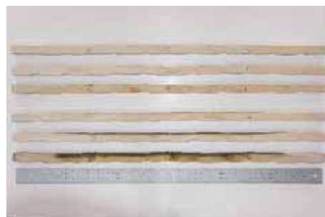
写真-103 試験後試験体パネル断面 ヒノキ 3 枚目パネル：下段 3 列 4 枚目パネル：上段 3 列
