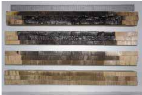
写真-173 試験パネル延焼面抜取り スギ 厚 65mm 1 枚目パネル：上段 3 列 2 枚目パネル：下段 3 列 3 枚目パネル：上段 3 列 4 枚目パネル：下段 3 列
