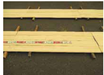
写真-54 製品試験パネル 厚 15mm ヒノキ 下：アメリカ試験用 上：日本確認試験用 製品位置確認状況
