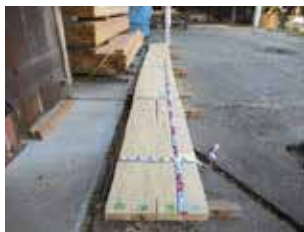
写真-44 製品試験体用原板 アメリカ試験用厚 65mm アカマツ
