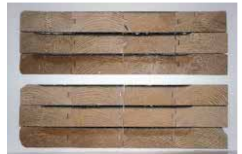
写真-178 試験パネル断面 カラムツ 厚 65mm 3 枚目パネル：上段 3 列 4 枚目パネル：下段 3 列
