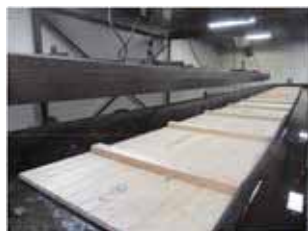
写真-125 試験前 アカマツ 15mm 2022 年 2 月 7 日 Intertek
