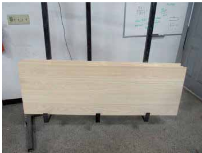
写真 No. 1 試験材料の露出面 (試験前)
