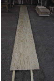
写真-76 製品試験パネル 厚 15mm カラマツ 試験面 アメリカ試験用
