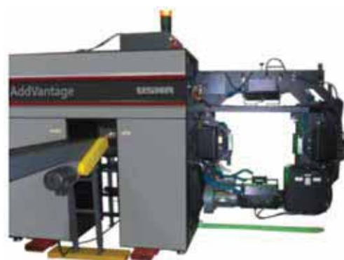
写真.5-5-7 AddVantage™ の外観と計測フレーム部分 (出典：USNR 社カタログ)
