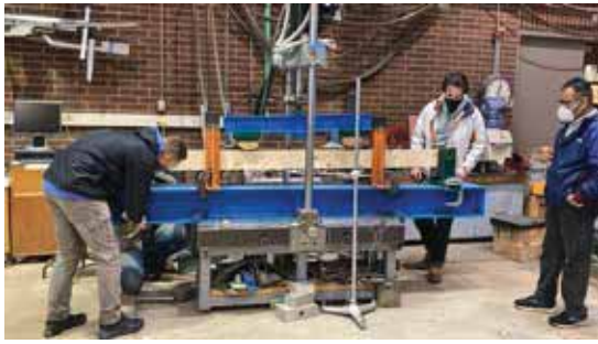
写真 5-3-5 汎用の強度試験機
