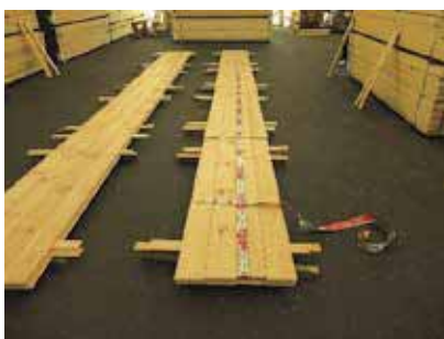
写真-59 製品試験パネル 厚 15mm アカマツ アメリカ試験用 製品位置確認状況
