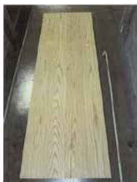
写真-104 試験パネル養生期間 6 日 カラマツ 15mm 2021 年 12 月 21 日 (社)電線総合技術センター
