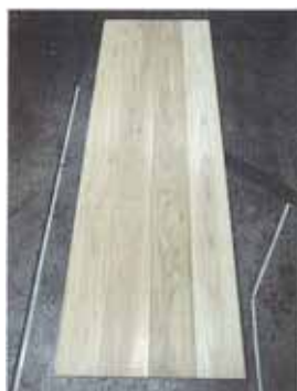
写真-92 試験パネル養生期間5日 スギ 15mm 2021年12月20日
