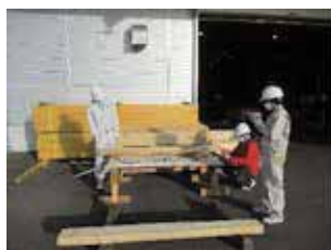
写真-41 製品試験体用原板 品質検査 ヤング率 E f 計測 アメリカ試験用厚 65mm ヒノキ
