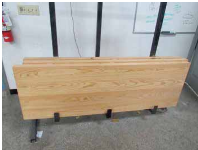
写真 No. 1 試験材料の露出面（試験前）
