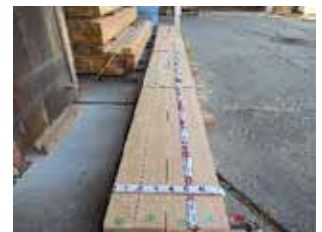
写真-47 製品試験体用原板 アメリカ試験用厚 65mm カラマツ
