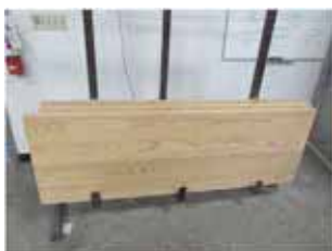
写真-144 試験パネル養生期間 6 日 カラマツ 65mm 2022 年 2 月 7 日 Intertek
