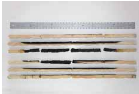
写真-165 試験パネル断面 ヒノキ 厚 15mm 1 枚目パネル：上段 3 列 2 枚目パネル：下段 3 列
