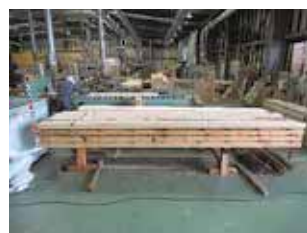
写真-15 製品試験体用原板 品質検査 アメリカ試験用厚 65mm アカマツ
