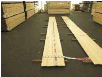
写真-52 製品試験パネル 厚 15mm ヒノキ 日本確認試験用 製品位置確認状況
