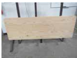
写真-120 試験パネル養生期間 5 日 カラマツ 15mm 2022 年 2 月 7 日 Intertek
