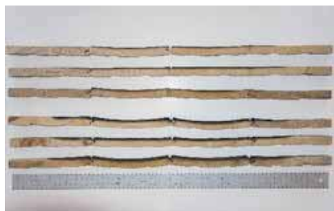
写真-115 試験後試験体パネル断面 アカマツ 3 枚目パネル：下段 3 列 4 枚目パネル：上段 3 列
