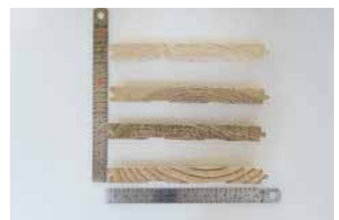
写真-49 製品加工 厚み 15mm 試験体断面 上から ヒノキ、アカマツ、スギ、カラマツ
