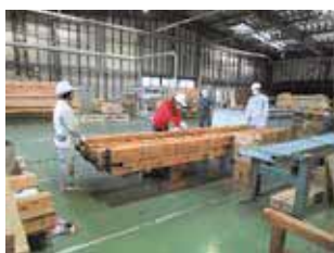
写真-13 製品試験体用原板 品質検査 アメリカ試験用厚 65mm スギ
