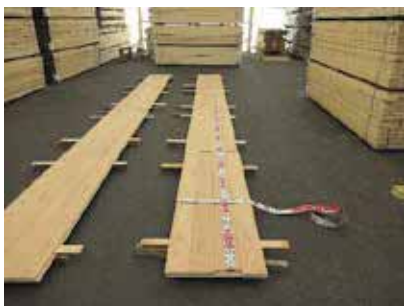
写真-56 製品試験パネル 厚 15mm カラマツ アメリカ試験用 製品位置確認状況
