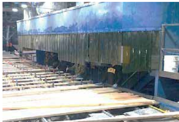
写真.5-5-1 アメリカの工場における複数による目視等級区分の作業の様子
