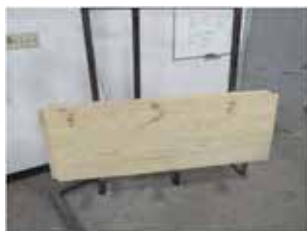
写真-124 試験パネル養生期間 5 日 アカマツ 15mm 2022 年 2 月 7 日 Intertek
