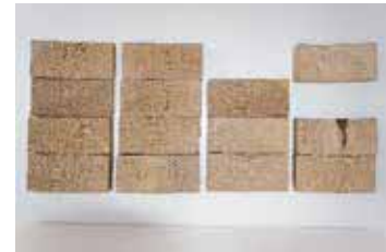
写真-37 アメリカ試験パネル原板 カラマツ 厚 65mm 用 左からパネル 1、2、3、4
