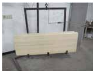
写真-132 試験パネル養生期間 5 日 ヒノキ 65mm 2022 年 2 月 7 日 Intertek
