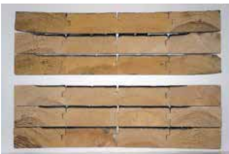
写真-171 試験パネル断面 アカマツ 厚 65mm 1 枚目パネル：上段 3 列 2 枚目パネル：下段 3 列
